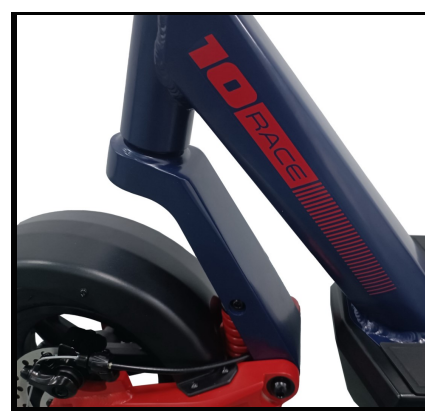
Přední odpružení s mechanickou kotoučovou brzdou
