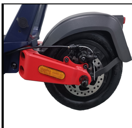
Zadní odpružené kolo s mechanickou kotoučovou brzdou
