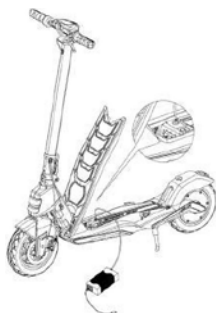
Ligue o carregador à porta de carregamento (B).
